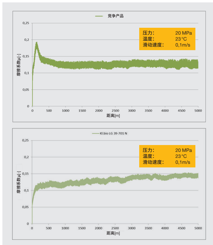
图2: 振荡摩擦磨损测试仪 (SRV) 分别使用 Klüberbio LG 39-701 N 和生物可降解竞品后的运行情况。
